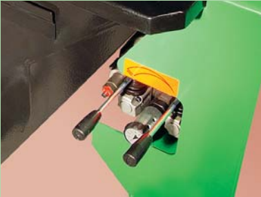
Válvulas de regulación para bomba y mezclador
